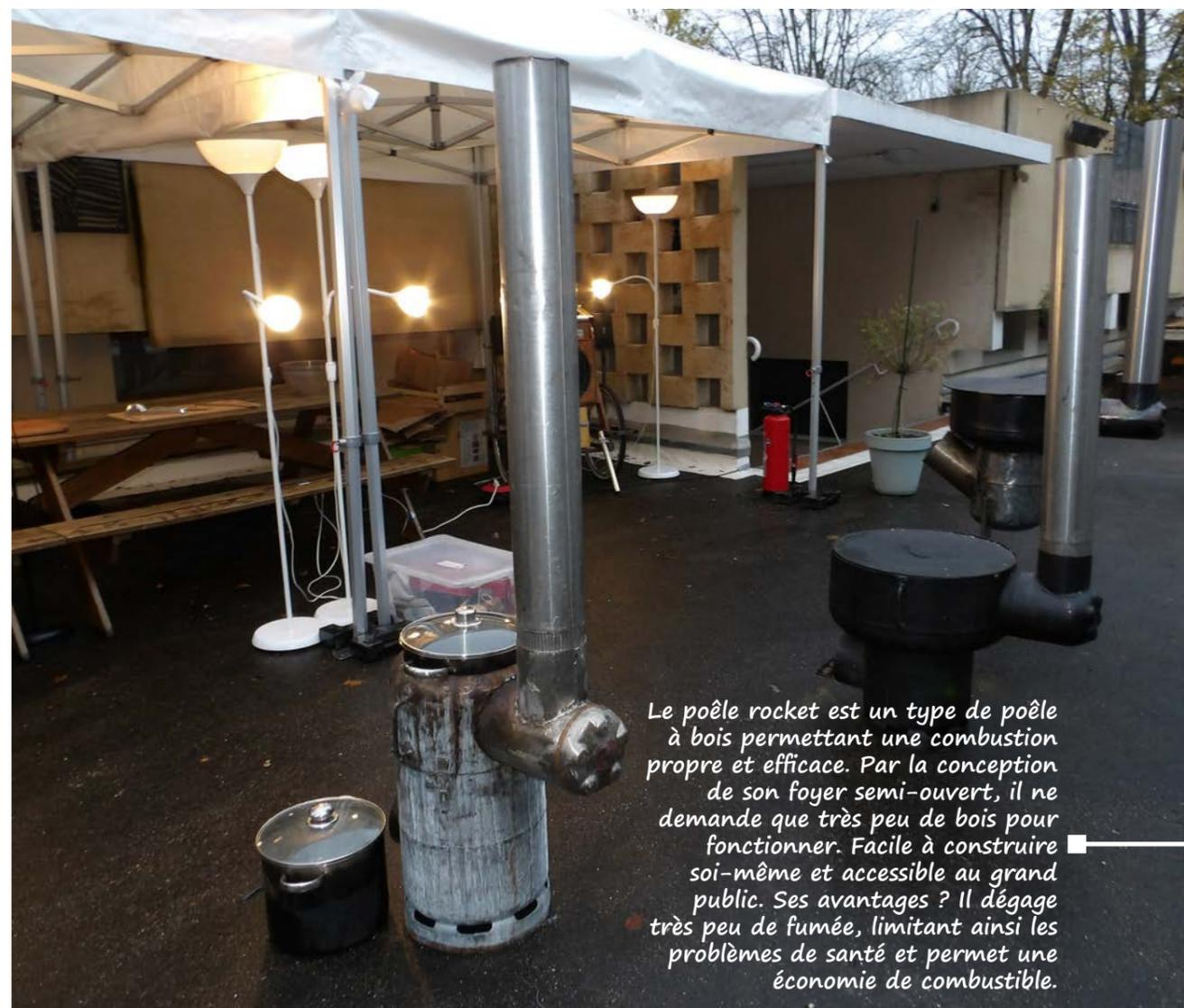
*Le poêle rocket est un type de poêle à bois permettant une combustion propre et efficace. Par la conception de son foyer semi-ouvert, il ne demande que très peu de bois pour fonctionner. Facile à construire soi-même et accessible au grand public. Ses avantages ? Il dégage très peu de fumée, limitant ainsi les problèmes de santé et permet une économie de combustible.*
